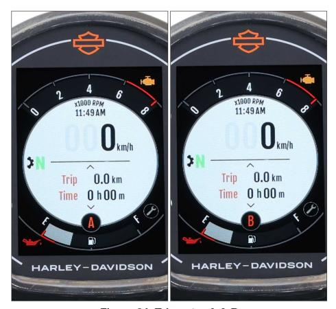
Figure 24. Tripmeter A & B
