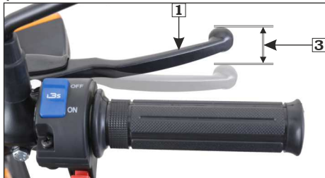
(1) फ्रंट ब्रेक लीवर (3) फ्री प्ले 10-20 mm
