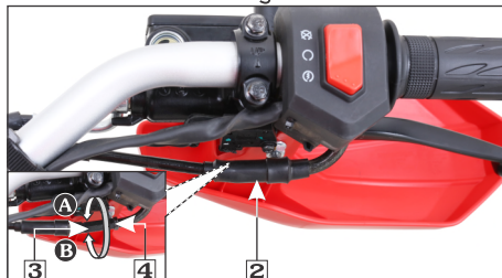
(2) बूट (3) एडजस्टर (4) लॉक नट (A) फ्री प्ले कम करना (B) फ्री प्ले बढ़ाना
