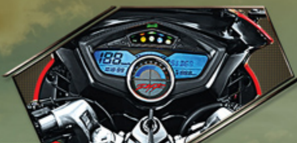
Consola digital multifuncional, sensor del soporte del lado e indicador de kilometraje en tiempo real
